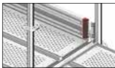
Montaje de rodapié de acero
