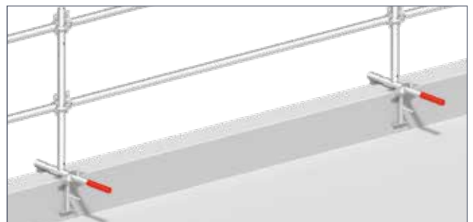
Ejemplo de aplicación de la mordaza para forjado en petos.
