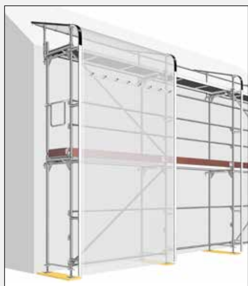
Uso de lona Keder en un andamio.
