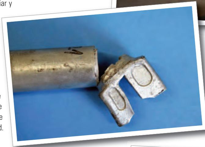
▶ En los ensayos realizados con horizontales, el 83 % resultaron defectuosas en la soldadura que une el cabezal y el tubo, lo cual, como se puede imaginar, ocasiona riesgos que son difíciles de evaluar.
