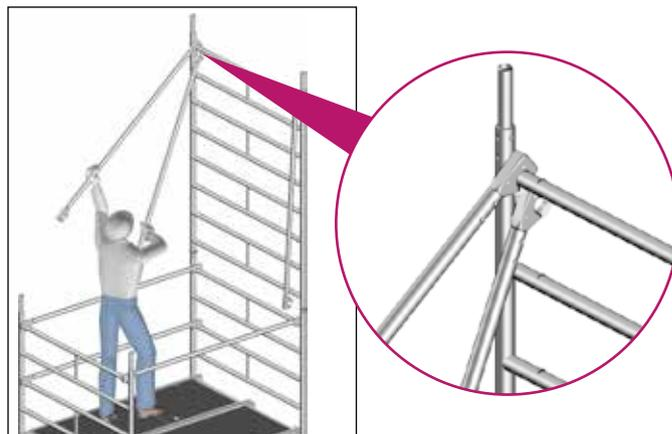
Cuando se desmonta una plataforma de trabajo o una intermedia, se han de retirar las barandillas del nivel superior desde el nivel inferior. Esto se realiza gracias a una barandilla instalada al nivel de la rodilla, que se apoya en el segundo travesaño desde arriba y se utiliza como palanca para abrir la garras de encaje (ver detalle).
