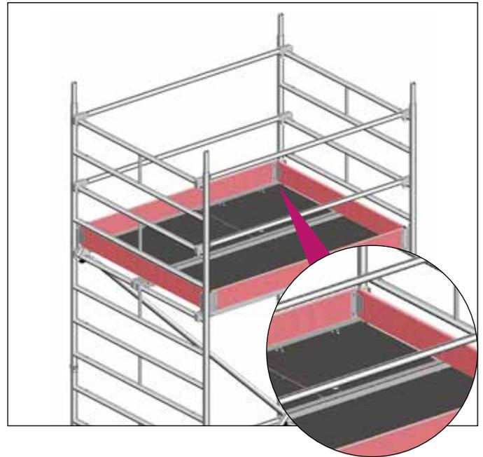
1. Para completar la plataforma de trabajo colocar el rodapié lateral 17 y el rodapié frontal 16.
