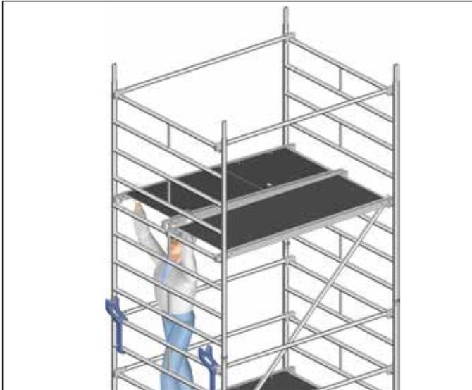
4. Insertar las diagonales 12, la plataforma 18 y la plataforma de acceso 19. Las diagonales tienen que instalarse como en una torre (en zig-zag) en ambos lados.
