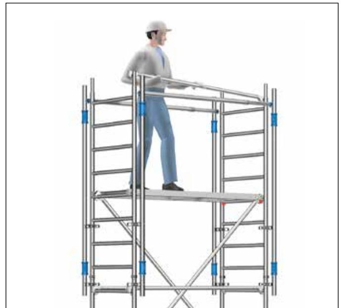
Fig. 6: colocación segura de las barandillas con AGS
