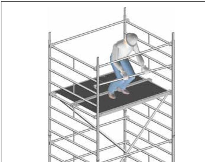
5. Subir al siguiente nivel e instalar las barandillas 8 a la altura de 0,5 metros (segundo peldaño encima de la plataforma).
