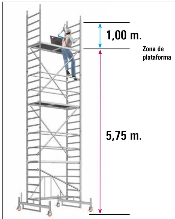
Fig. 2: alturas mínimas para el uso del EPI
