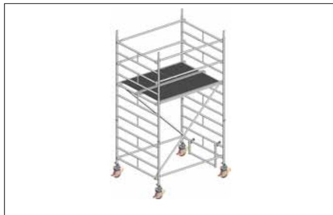
3. Inclinarse el marco con las barandillas en la parte superior y luego insertar el marco y asegurarlo con pasadores con muelle 20.
