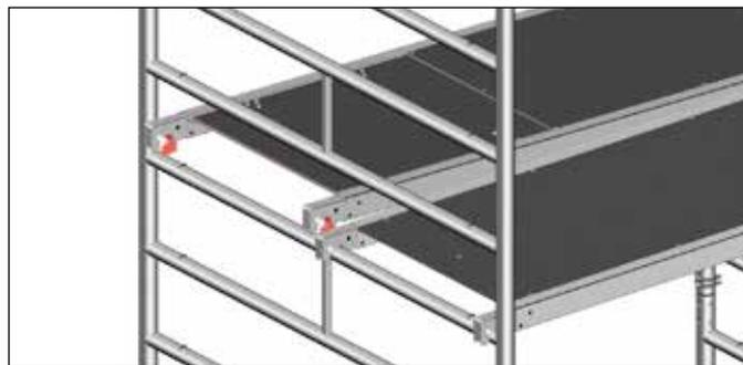
Las garras de encaje rojas de las plataformas permiten un montaje y desmontaje sin esfuerzo por una sola persona. Primero abrir los cierres, levantar la plataforma y apoyarla sobre el travesaño del marco, después realizar la misma operación en el otro lado.
