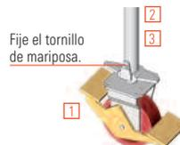
Durante el montaje, y mientras se trabaje, las ruedas deben estar frenadas pisando la palanca del freno marcado con STOP [3]. El freno está puesto cuando la palanca marcada con STOP está abajo. Para mover la torre, se quita el freno de las ruedas al presionar el otro lado de la palanca del freno. La elección de piezas (páginas 10 - 11). Las ruedas están identificadas en su carcasa.
