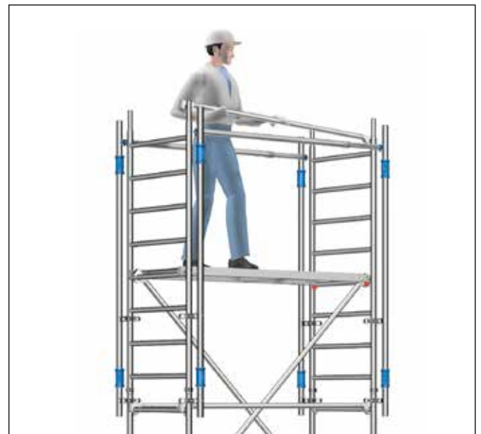
Fig. 6: Colocación segura de las barandillas con AGS
