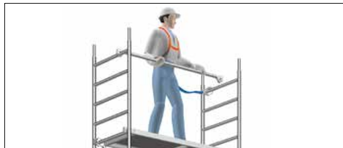
Fig. 3: Colocación de las barandillas con EPI
